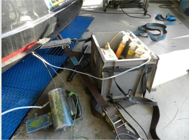
**Photo 4: Montage de Bureau Veritas pour réaliser les prélèvements de poussières, prélèvements manuels et gaz en continu**
